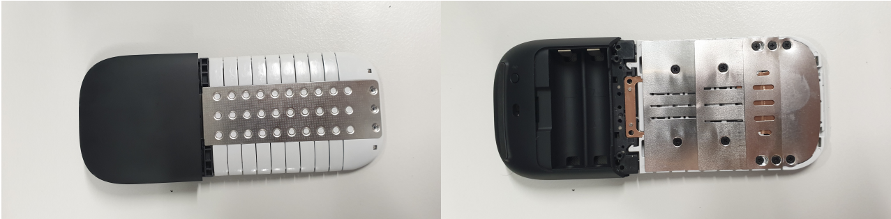
FIGURE 16 – Structure de l’armature extérieure, vue de haut à droite et vue de bas à droite
